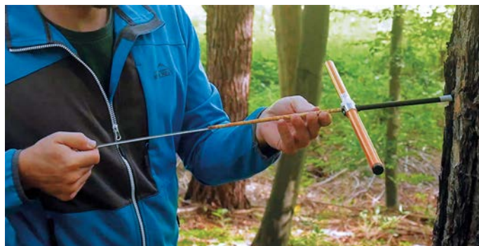
Probennahme eines Bohrkerns mit Hilfe eines Zuwachsbohrers
